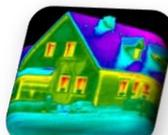
**Thermographie Infrarouge :** contrôle permettant de visualiser la température de surface de tout support. Contrôle des déperditions énergétiques.
